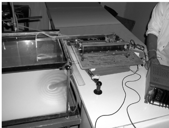
Figure 7 : Photographie de la cuve et de la source d'air pulsé en mouvement.
